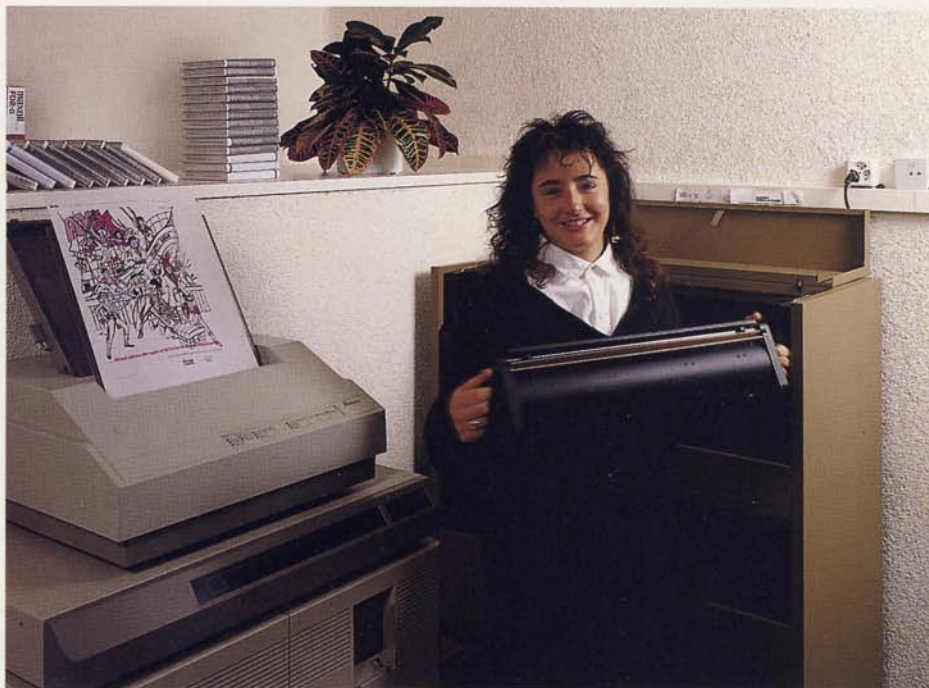
Désirée Müller (Setzerin) wechselt die Materialkassette des 2051-Laserbelichters. Das Maximalformat beträgt 51×62 cm. Am linken Rand sind der A3-Laserprinter und ein Thermotransfer-Drucker für farbige Kopien zu erkennen.
